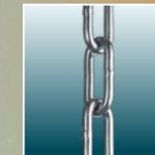
Catena a maglia lunga per pontili galleggianti. Resistenza a rottura pari a 40 kg/mm<sup>2</sup> secondo le norme DIN5685/c e DIN763.
