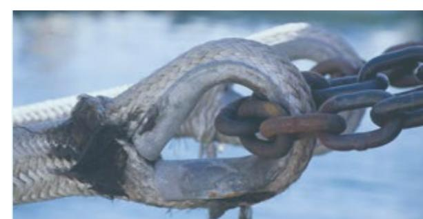
L'ormeggio può essere effettuato anche mediante trappe, cime non galleggianti, legate ad un corpo morto come la catena. Esse forniscono un collegamento affidabile e sicuro tra l'imbarcazione e la banchina.
