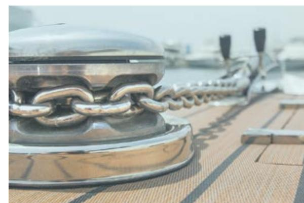
I verricelli sono dispositivi meccanici che facilitano l'affondo e il recupero dell'ancora tramite l'utilizzo della catena. A seconda del verricello presente sull'imbarcazione è necessario acquistare la catena adeguata. Tutta la catena MF viene calibrata per garantire dimensioni precise che ne consentano un corretto uso e scorrimento sul verricello.
