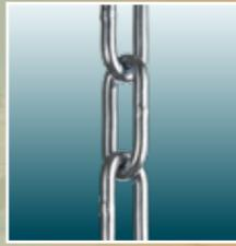
Catena a maglia lunga per acquacoltura con resistenza a rottura pari a 40 kg/mm<sup>2</sup> secondo le norme DIN5685/c e DIN763.
